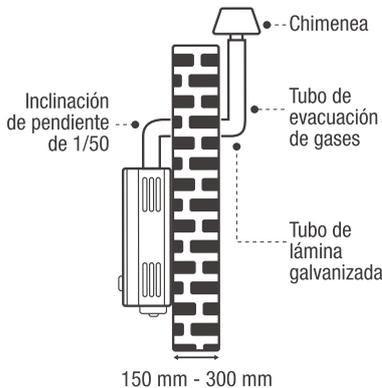
**Para evitar pérdida de calor, el calentador se debe ubicar a una distancia máxima de 5 metros de las áreas en las que se utilizará el agua caliente**
