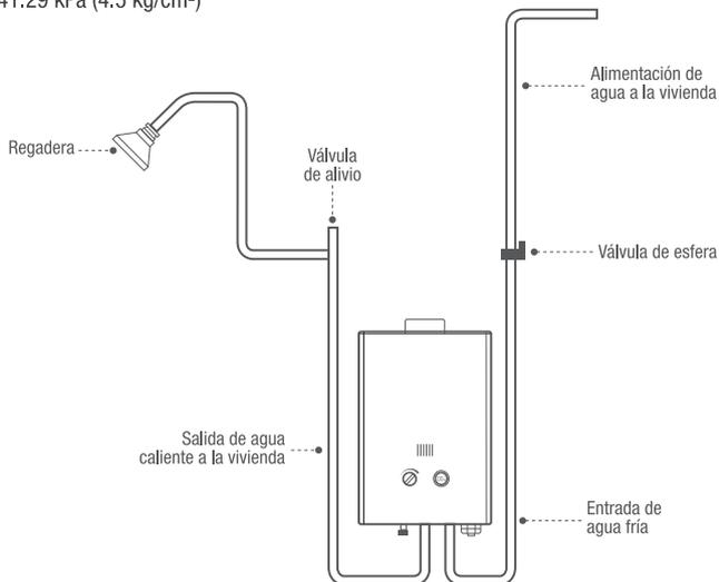
**⚠ PELIGRO** NO INSTALE el calentador en lugares cerrados, mal ventilados o cercanos a material inflamable. En el caso de que el calentador requiera un ducto para la correcta extracción de los gases de combustión, éste debe ser exclusivo para la salida de los gases del calentador.
